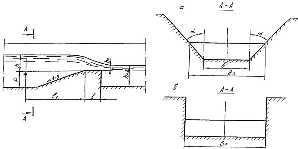
а - в каналах трапецидального поперечного сечения
