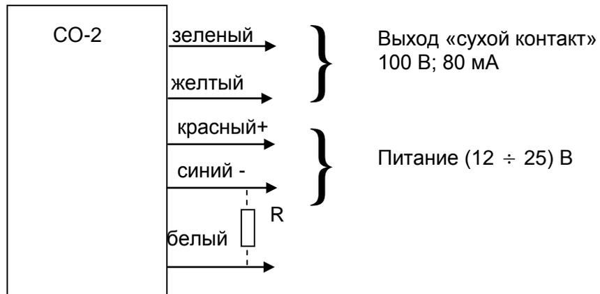
Допускается регулировка чувствительности сигнализатора подключением внешнего резистора  $100 \text{ Ом} < R < 30 \text{ кОм}$  (30 кОм – срабатывание на мутной воде; 100 Ом – срабатывание на плотном иле). Набор резисторов для регулировки входит в комплект поставки.
